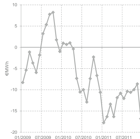
Abbildung 1: Mittlerer monatlicher Clean Spark Spread; Basis Spotpreisnotierungen, Wirkungsgrad 48%
